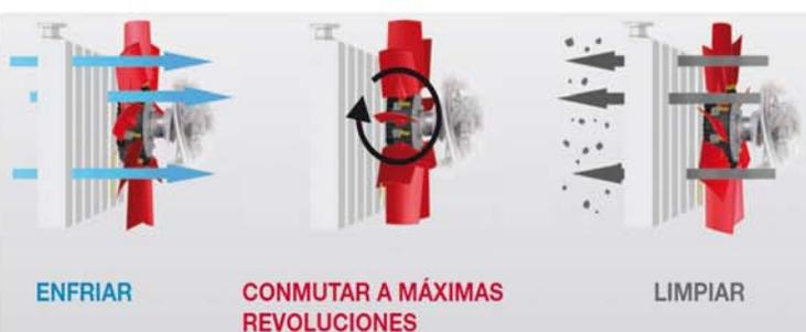
El modelo SZ357 dispone de un **innovador ventilador reversible**, que no sólo aspiran aire, sino que también pueden soplar enérgicamente para limpiar el radiador. Dicho ventilador ofrece un mayor y óptimo flujo de aire de limpieza gracias a la orientación exacta del perfil de las paletas sin modificar el sentido de rotación ¡ puede girar sobre su propio eje en posición transversal!. Las ventajas sobre la máquina se traducen en:
