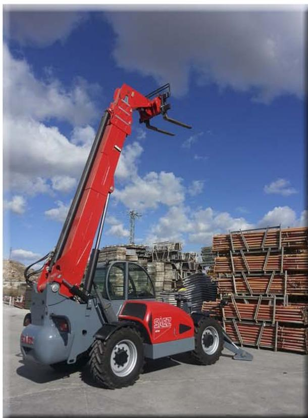
El manipulador SZ4017 va equipada con una cabina diseñada expresamente para asegurar el confort del operario, es espaciosa, tiene gran visibilidad y la disposición de los mandos es muy ergonómica. Con respecto a los puntos de mantenimiento se ha optimizado mucho la máquina para abaratar en este campo del mantenimiento considerablemente. El modelo SZ4017 también podrá ofrecer múltiples posibilidades funcionales mediante gran variedad de implementos.
